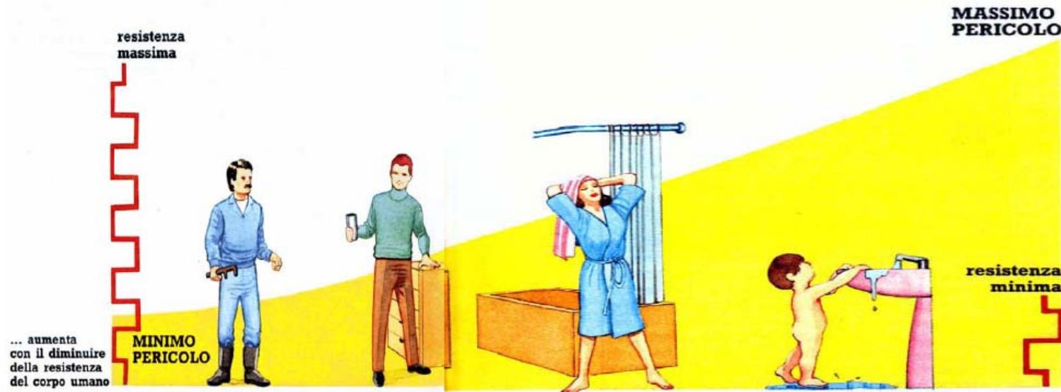
$V = R \times I$ , quindi:  $I = V/R$  ovvero a parità di resistenza una minor tensione implica un passaggio di corrente minore
